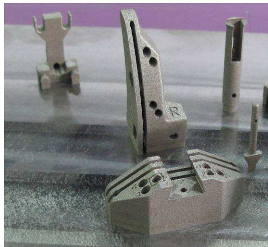
Figura 4. Arriba: detalle de Guía de resección distal femoral MIS. Debajo: varias piezas metálicas fabricadas por SLM en AIMME.
