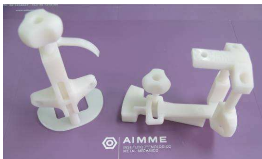
Figura 3. Arriba: piezas de plástico fabricadas por Estereolitografía en AIMME. Debajo: Ensamblajes de plástico de: Guía de perforación/medidor femoral MIS y Guía multiangular alineación femoral MIS
